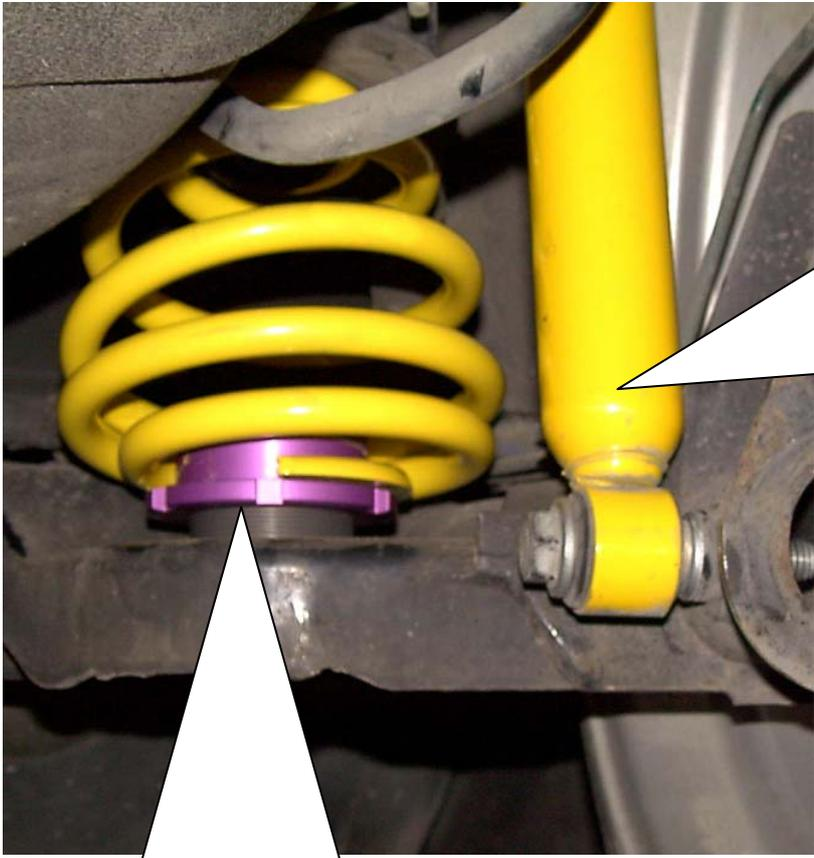
Sofern im Lieferumfang keine Anschlagpuffer enthalten sind, werden die serienmäßige Anschlagpuffer in ungekürzter Ausführung weiterverwendet. Diese müssen sich in einem einwandfreiem Zustand befinden und sind ggf. zu erneuern.
