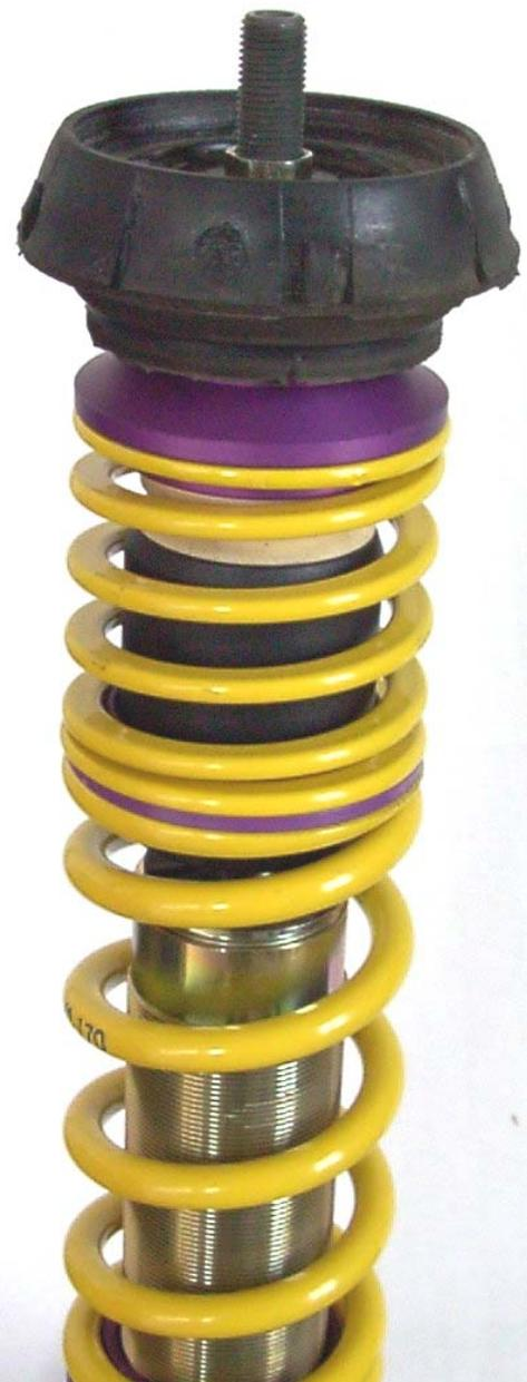
Nach erfolgtem Einbau des Fahrwerkes ist die Freigängigkeit der Bereifung zum VA-Federbein zu überprüfen. Das Mindestabstandsmaß darf an der engsten Stelle **5 mm** nicht unterschreiten und ist gegebenenfalls mittels handelsüblicher, TÜV geprüfter Distanzscheiben wieder herzustellen.
