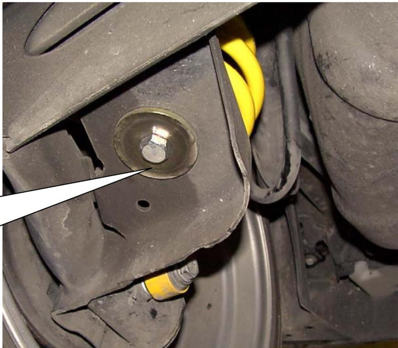
Höhenverstellung einsetzen und mit Unterlagscheibe und Schraube verschrauben (Anzugsmoment 40 Nm).
