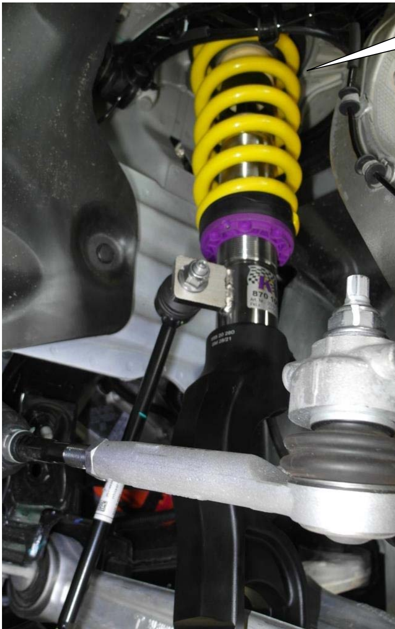
Montiertes Federbein. Installed coilover strut.
