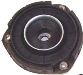
Das Original Domlager aufsetzen und mit der im Lieferumfang enthaltenen Mutter festschrauben. Das Anzugsdrehmoment der Kolbenstangenbefestigung beträgt 50 Nm. Die Montagehinweise zum Einbau des Federbeines in das Fahrzeug, sowie die Anzugsdrehmomente der Federbeinbefestigung, entnehmen Sie bitte den Unterlagen des Fahrzeugherstellers.
