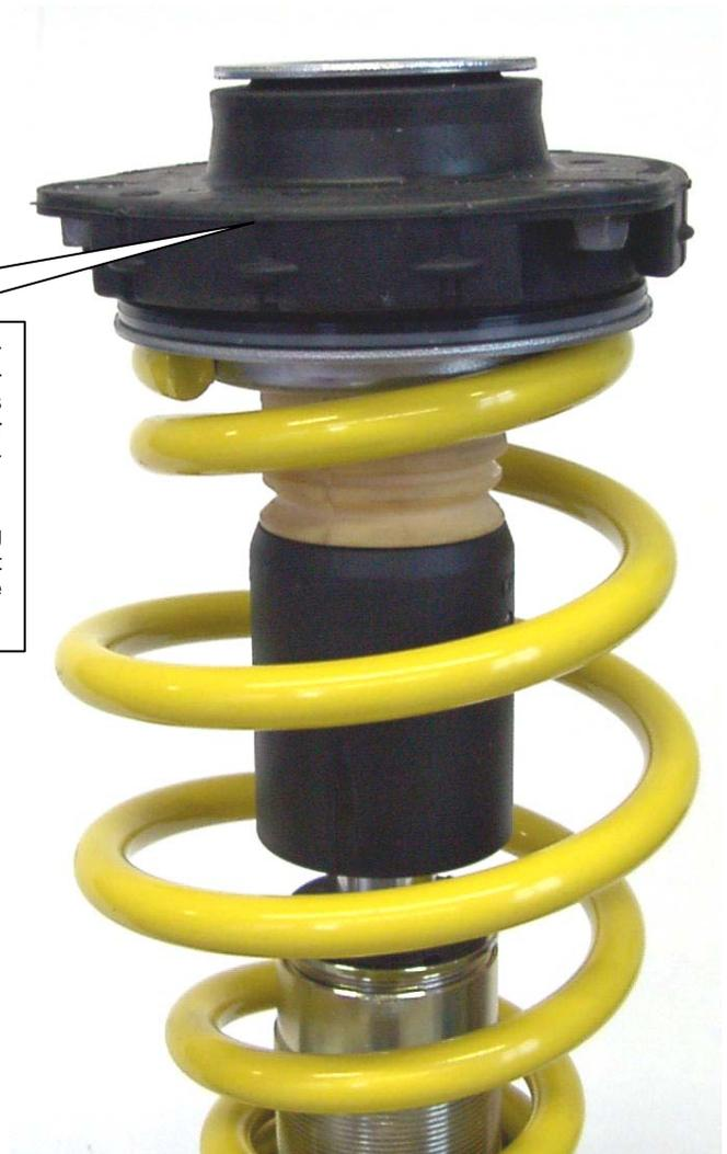
Nach erfolgreichem Einbau des Fahrwerkes ist die Freigängigkeit der Bereifung zum VA-Federbein zu überprüfen. Das Mindestabstandsmaß darf an der engsten Stelle **5 mm** nicht unterschreiten und ist gegebenenfalls mittels handelsüblicher, geprüfter Distanzscheiben wieder herzustellen.
