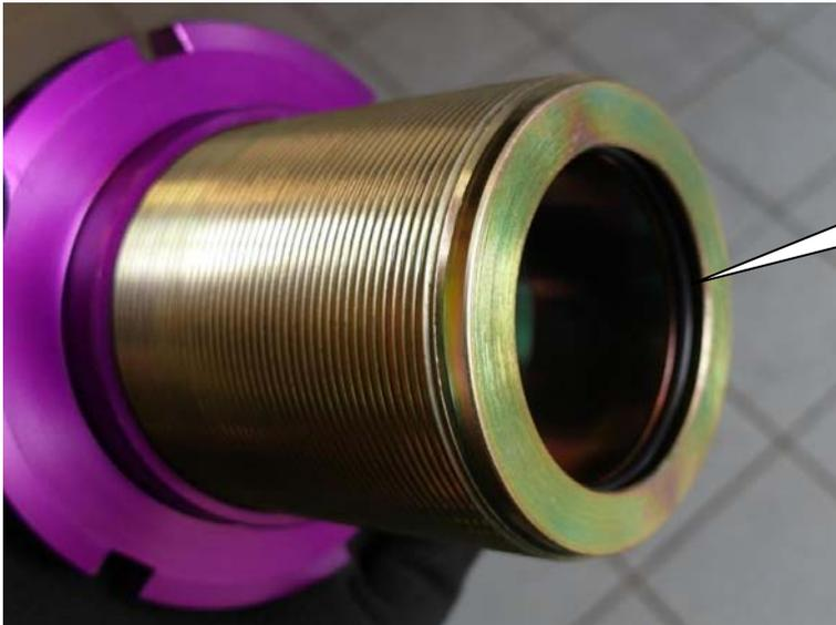
Gewindehülse komplett innen und an der oberen Dichtung einfetten.
