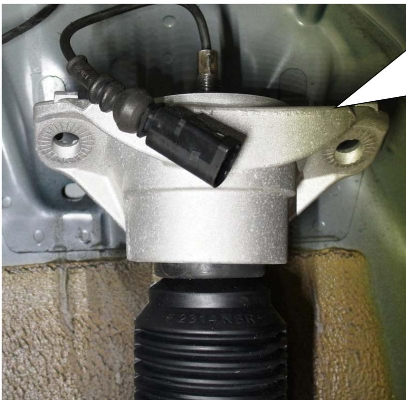
Original Stützlager aufstecken und mit der original Mutter verschrauben.
