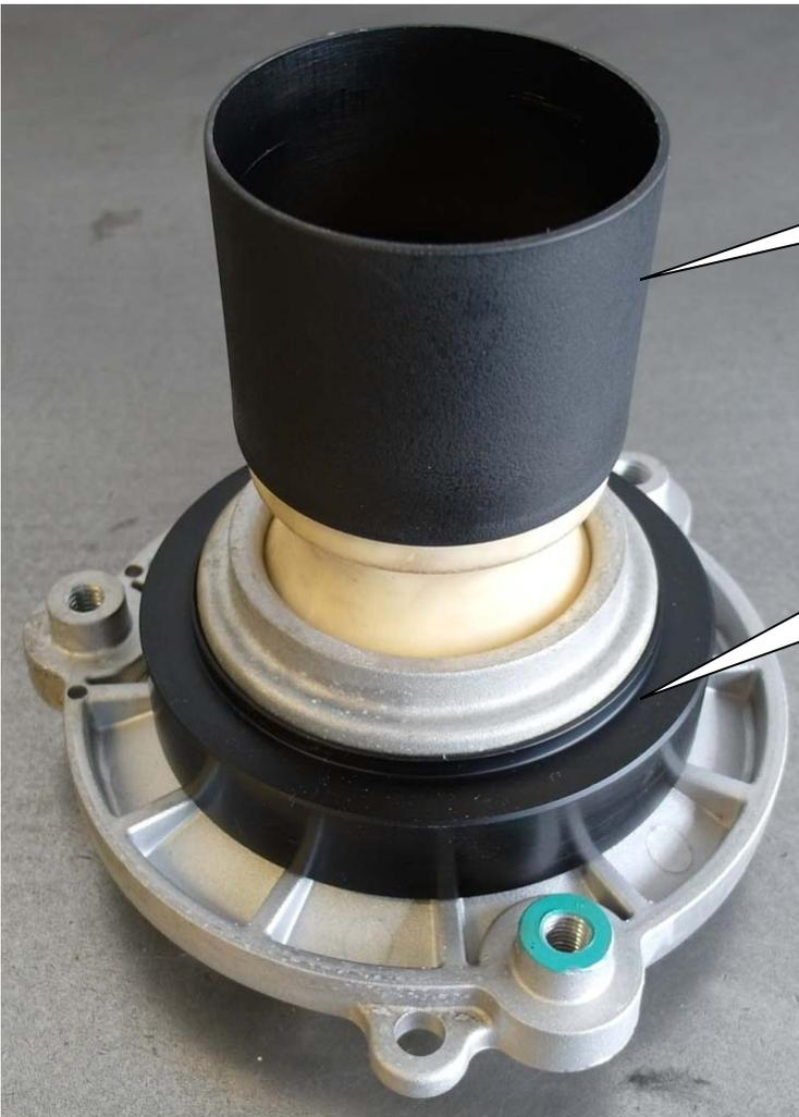
Mitgelieferter Federwegsbegrenzer + Staubschutzrohr in das Stützlager eindrücken.
