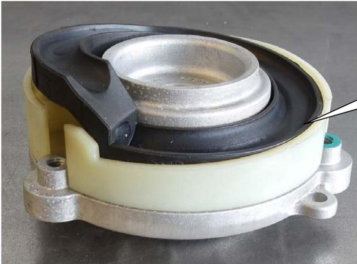
Alle Teile vom Originalstützlager entnehmen. Diese Teile werden nicht mehr benötigt.
