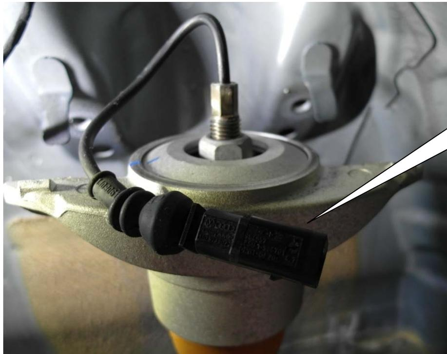
OEM Stecker mit geeignetem Werkzeug demontieren. Pin und Kabelfarbe notieren.
