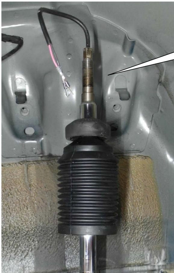
Faltenbalg und Zusatzanschlagelement auf den Dämpfer aufstecken.
