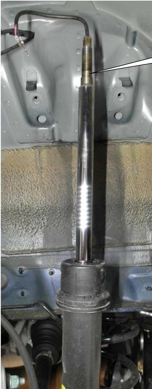
Original Anschlagelement und Faltenbalg entfernen. Diese werden nicht mehr benötigt.
