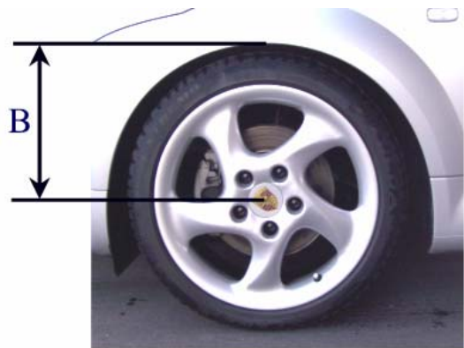
Abstandsmaß B - Radmitte - Kotflügelunterkante
