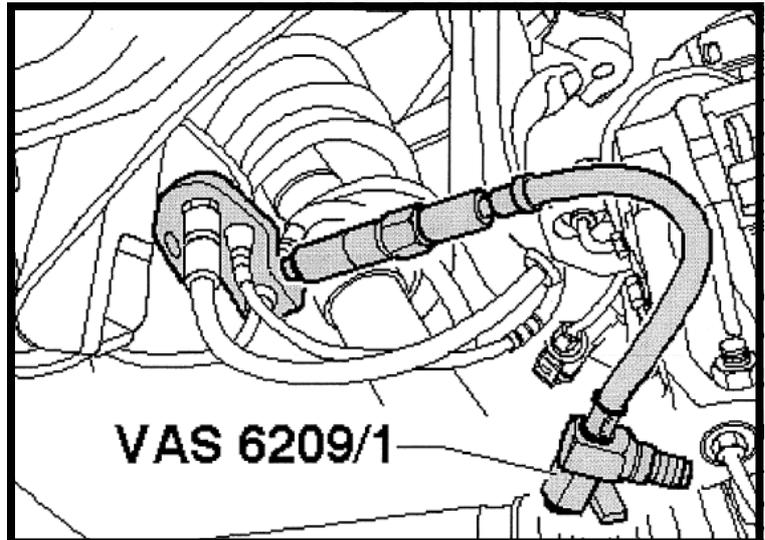
Die Flexible Leitung, die zum Dämpfer führt, abklemmen und mit dem mitgelieferten Verschlussstopfen verschließen.
