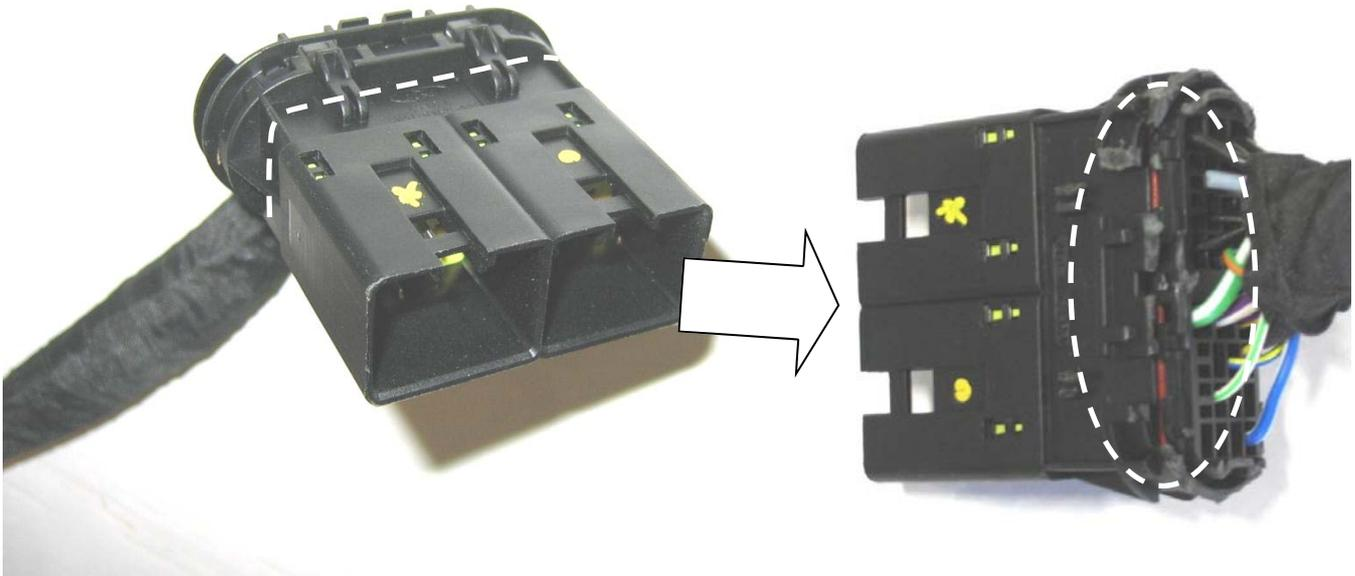
5.) Original Kabelbaumdurchführung mit der Abdeckung (C) und Schrauben (P) verschließen (erforderliche Bohrung: Ø 2 mm) und zusätzlich mit Karosseriekleber (V) abdichten.
