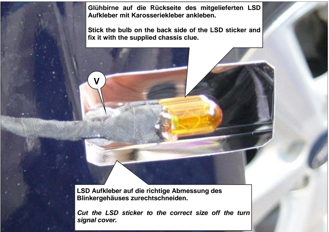
**LSD Aufkleber auf die richtige Abmessung des Blinkergehäuses zurechtschneiden.**
