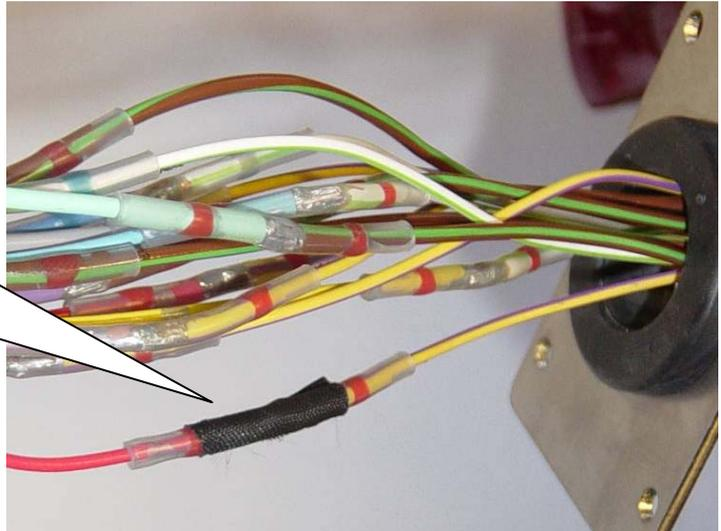
Am Schluss dann den kompletten Kabelbaum mit Hilfe des Gewebelandes wieder ummanteln.
