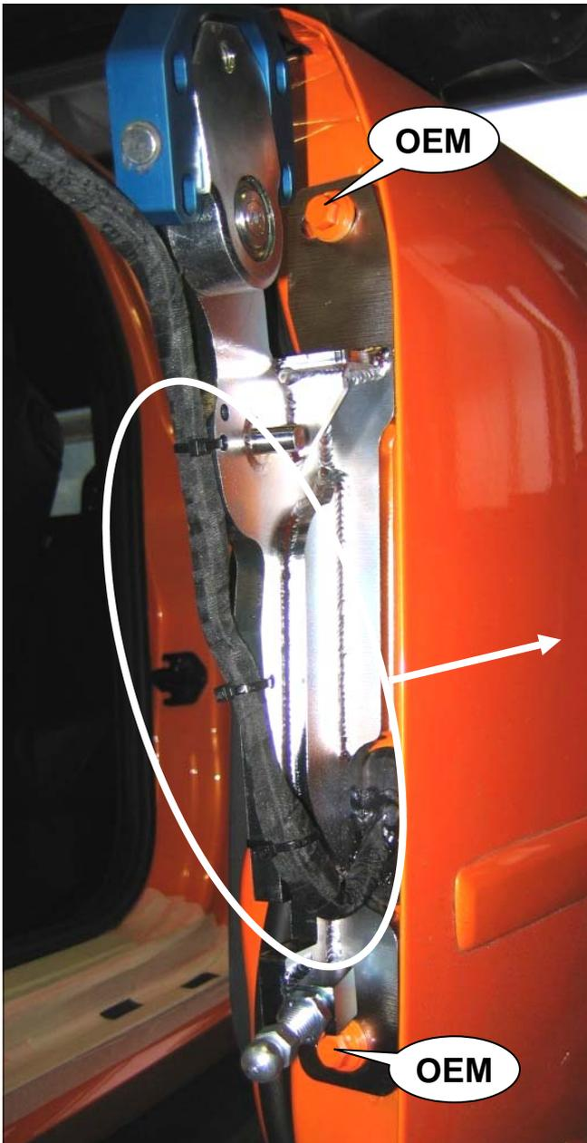
10.1.) Kabel verlegen und mit Kabelbinder (**B**) an den markierten Punkten befestigen.
