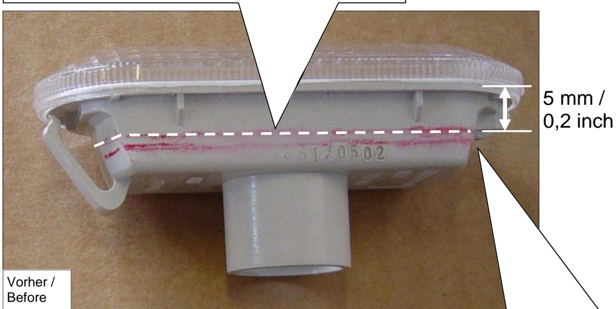
Für das Kabel muss ein Loch auf der Seite gebohrt werden.
