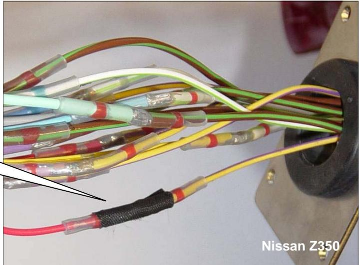
Am Schluss dann den kompletten Kabelbaum mit Hilfe des Gewebeklebebandes wieder ummanteln. Achtung: Kabel beim ummanteln gerade halten.
