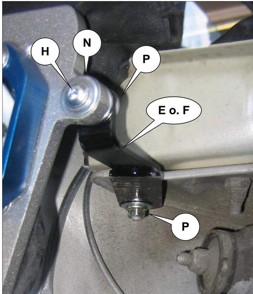
21.) Für einen Freigängigkeitstest bitte nun den bearbeiteten Kotflügel am Fahrzeug fixieren.
