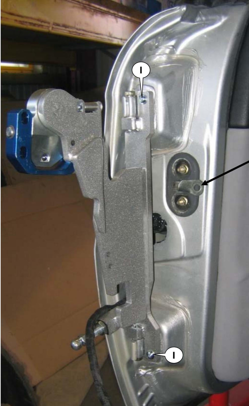
Original Tüfangband nach innen drücken und ankleben oder Tüfangband komplett demontieren.
