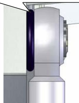
**Die Dämpferkennzeichnung muss sichtbar sein / The signification on the gas spring must be visible**
