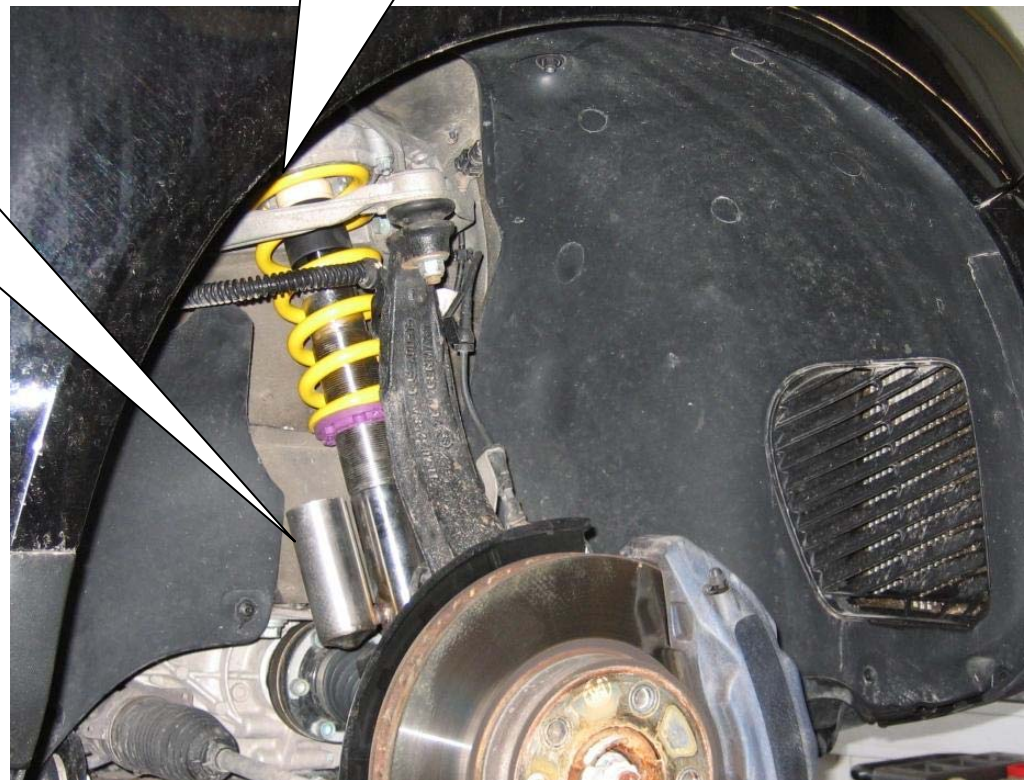
Eingebautes Federbein im Fahrzeug. Assembled coilover strut in the car.
