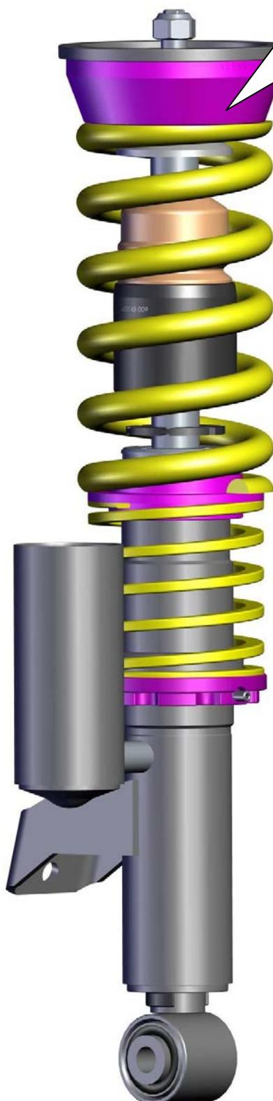
Das Serienstützlager auf das Federbein aufsetzen und verschrauben. Auf der Unterseite wird die mitgelieferte und auf der Oberseite die original Stützscheibe verwendet. Das Anzugsdrehmoment der Kolbenstangenbefestigung beträgt 40 Nm. Die Montagehinweise zum Einbau des Federbeines in das Fahrzeug, sowie die Anzugsdrehmomente der Federbeinbefestigung, entnehmen Sie bitte den Unterlagen des Fahrzeugherstellers.
