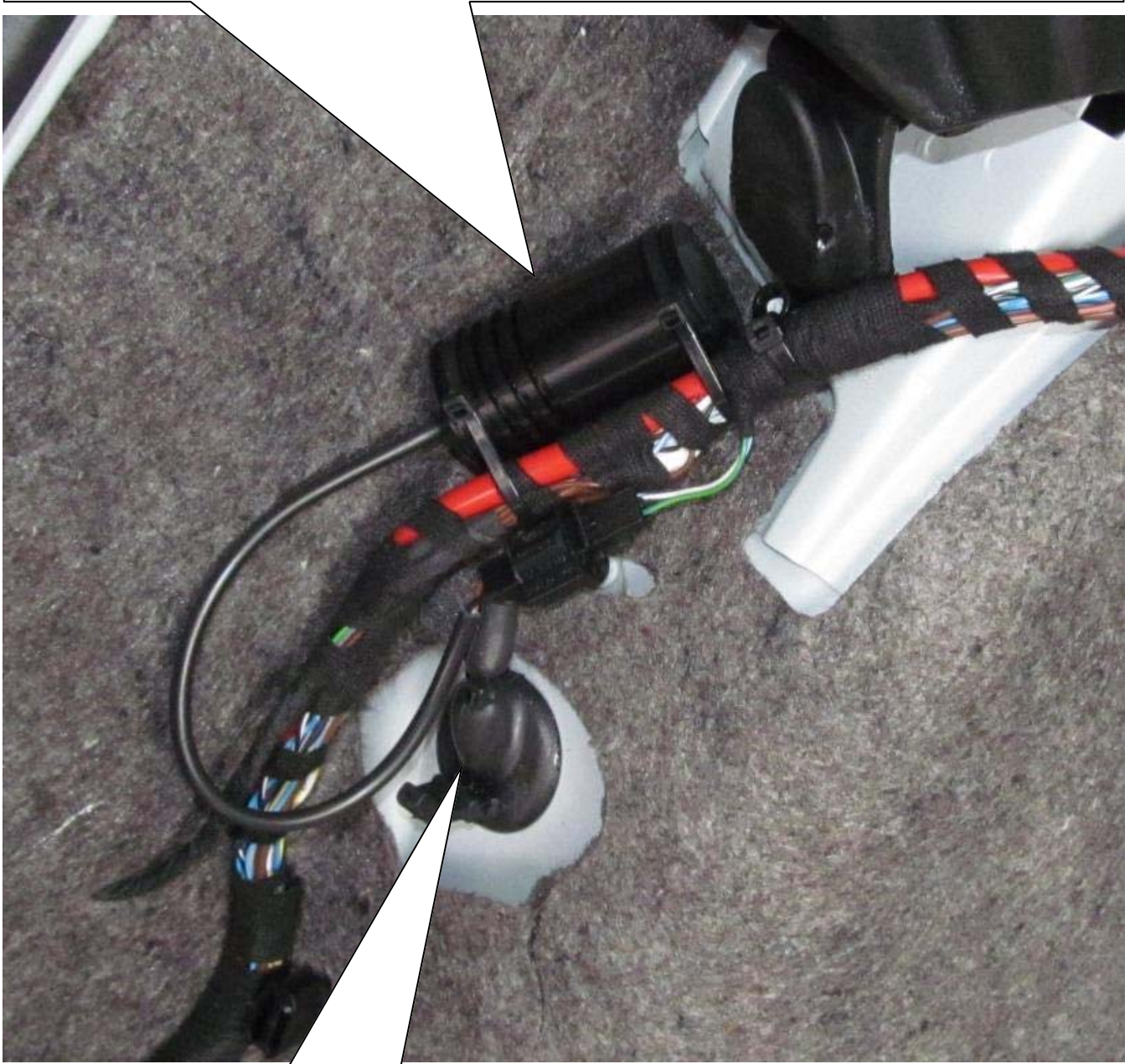
Original Kabeltülle mit einem Kabelbinder verschließen. Close the original grommet it with a cable tie.
